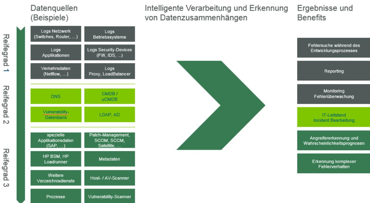
Im ersten Reifegrad eines ITOA-Systems werden verschiedene Logdaten ausgewertet, um die Fehlersuche während des Entwicklungsprozesses zu vereinfachen, ein Reporting zu etablieren und ein IT-übergreifendes Monitoring zu ermöglichen. Das ITOA-System fungiert hier als Single Point of Truth - alle IT-Betriebsdaten werden an einer Stelle zentral gesammelt und auswertbar gemacht. So ist eine End-to-End-Betrachtung der IT möglich.
