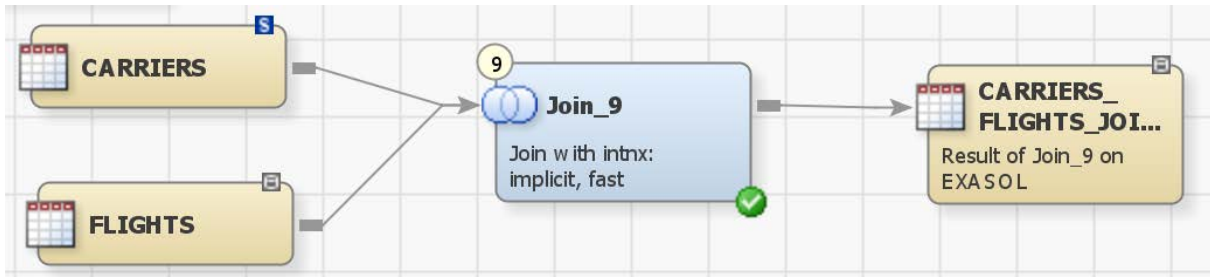
Abbildung 8: Aufbau, Inner-Join mit Tabellen aus SAS® und EXASolution, implicit Pass-Through
